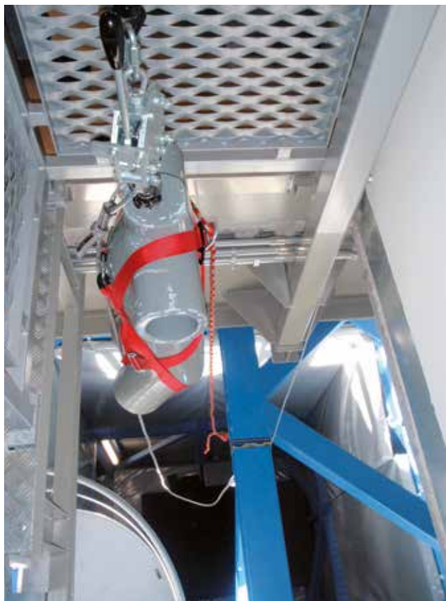
Drop test of a full body harness in the C.A.M.P. R&D. Test de caída de un arnés integral en la torre del departamento de I+D de C.A.M.P. Premana, Italy (© C.A.M.P.).
